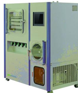
冻干箱是一个能够致冷到 $-40^{\circ}\text{C}$ 左右，能够加热到 $+50^{\circ}\text{C}$ 左右的高低温箱，也是一个能抽成真空的密闭容器。它是冻干机的主要部分，需要冻干的产品就放在箱内分层的金属板层上，对产品进行冷冻，并在真空下加温，使产品内的水份升华而干燥。
